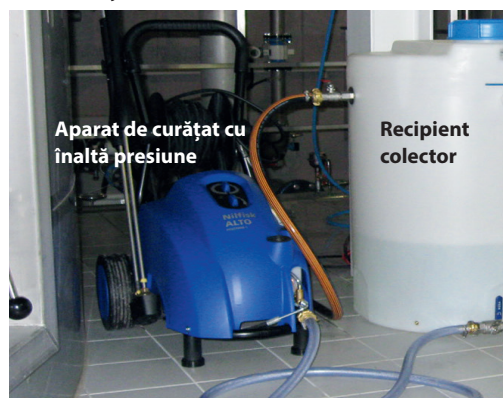
Utilizarea de produse de curățat cu pH neutru, cu ajutorul aparatului de curățat cu înaltă presiune
