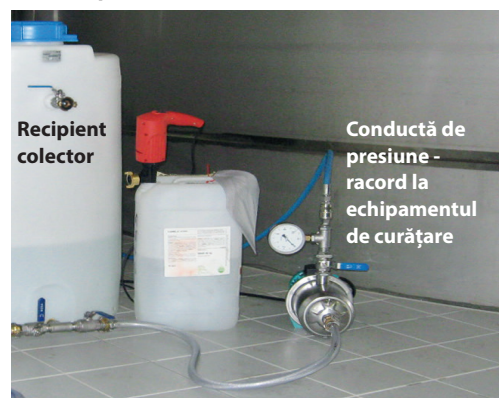
Utilizarea de produse de curățare acide cu o pompă separată, rezistentă la acizi
